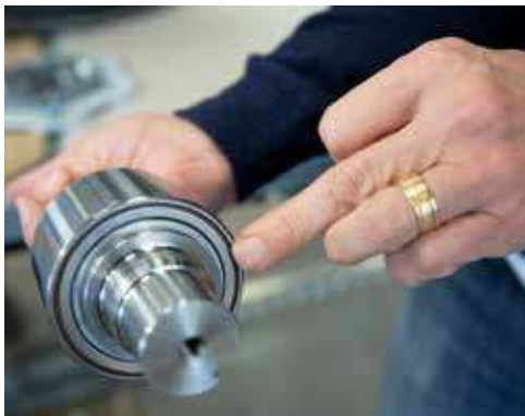
Tack vare en rad smarta tätningslösningar som en hub-unit och nitrilgummit SKF Duralip lyckades man skapa en maskin med extremt hög driftsäkerhet.
